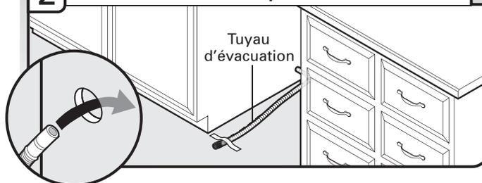
Installer le tuyau d'évacuation comme on le voit sur l'illustration, à travers le trou percé dans la paroi du placard, jusqu'au point à l'avant/au centre de la cavité d'encastrement où le raccordement sera effectué sur l'appareil. Fixer le tuyau d'évacuation sur le sol avec du ruban adhésif à l'emplacement indiqué, pour qu'il ne puisse bouger lors de l'insertion du lave-vaisselle dans la cavité.
